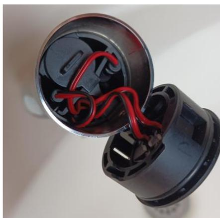
Une fois le bouton repositionné dans le capot, insérer le boîtier pile et les connectiques de part et d'autre des éléments internes avant de refermer le capot et de dévisser la vis de blocage.
