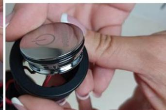
Pour le montage du nouveau bouton, bien penser à aligner l'encoche sur le bouton avec le détrompeur du capot.
