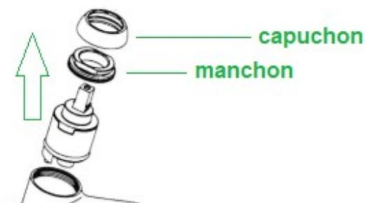
Pour le remontage, il faut procéder dans l'ordre inverse en prenant soin de nettoyer la surface du corps où agissent les joints d'étanchéité de la cartouche. Serrer le manchon afin de garantir à la fois l'étanchéité et en même temps le mouvement souple de la manette.
