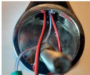
Replacer la cale en prenant soin de l'orienter dans le bon sens : le trou permettant l'extraction vers l'extérieur. Il reste alors à procéder au branchement de l'électrovanne et de la pile, puis à remettre en place la tête (couple de serrage de 2 N.m) en ayant glissé le tuyau sous la cale.
