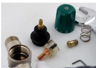
Retirer l'écrou, la navette et le ressort
