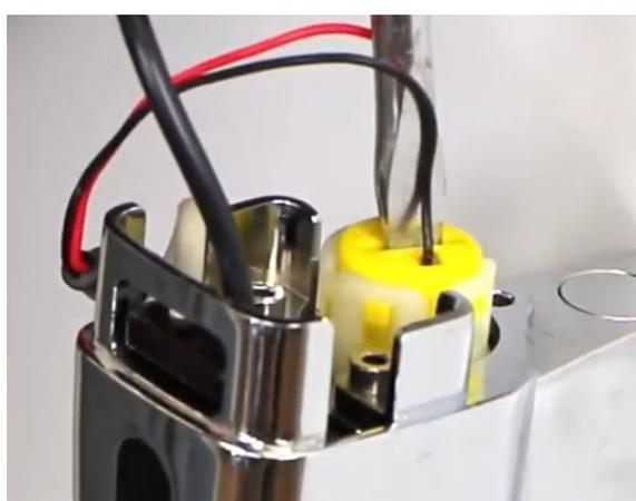
Rebrancher les connectiques en respectant les détrompeurs, enfin, remettre le capot
