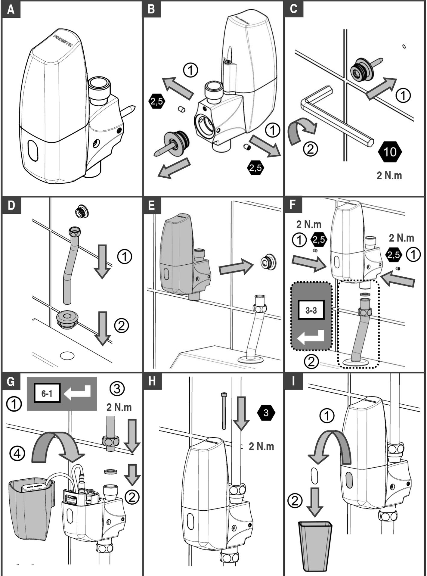
**3-3 Montage de l'effet d'eau / Installation of the water effect / Einbau der Sprühdüse / Montaje del efecto agua / Montaggio del tubo di adduzione / Montage van het watereffect**
