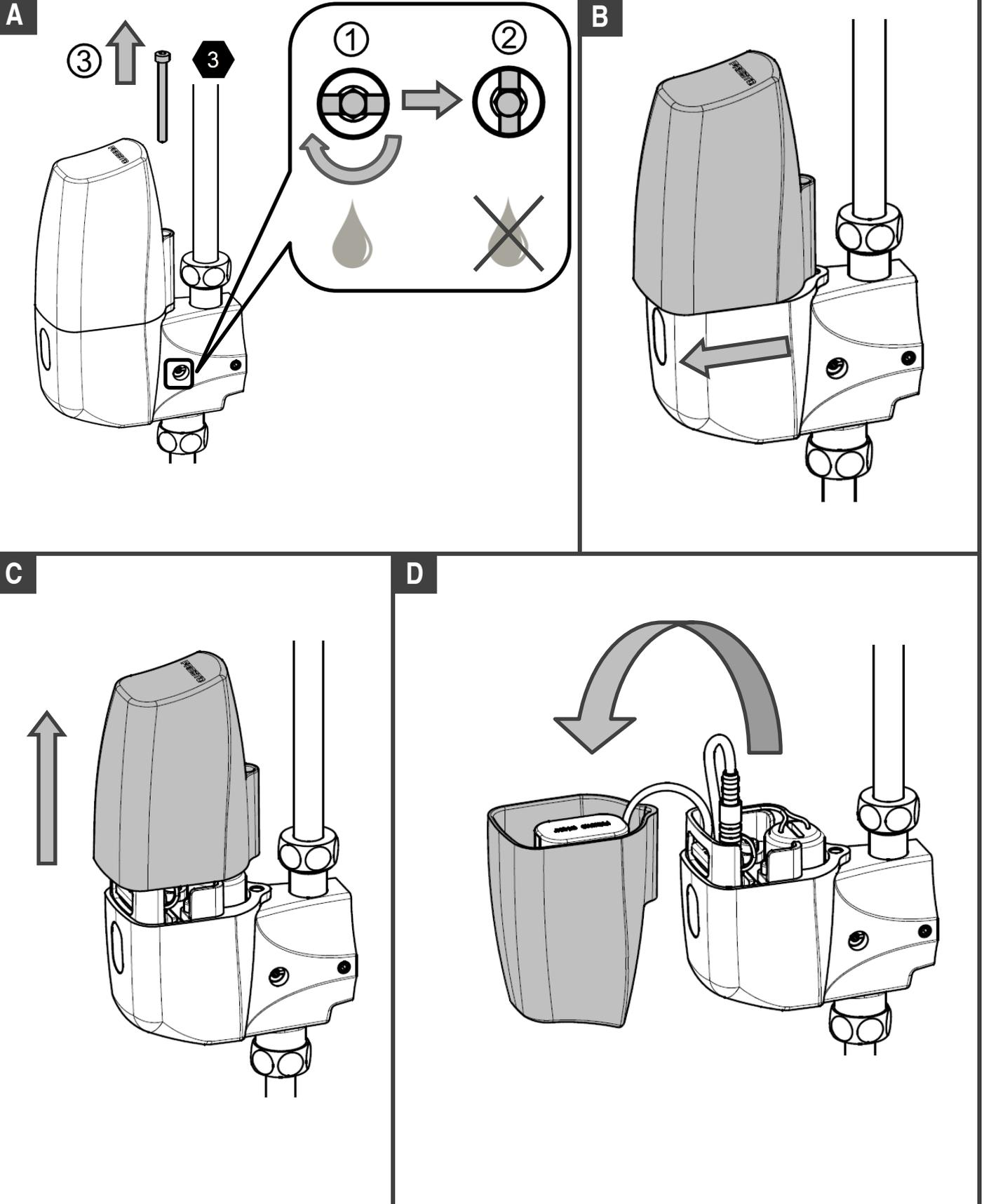
**6-2 Remplacement la pile / Changing of the battery / Auswechseln der Batterie / Sustitución de la pila / Sostituzione della pila / Vervanging van de batterij**
