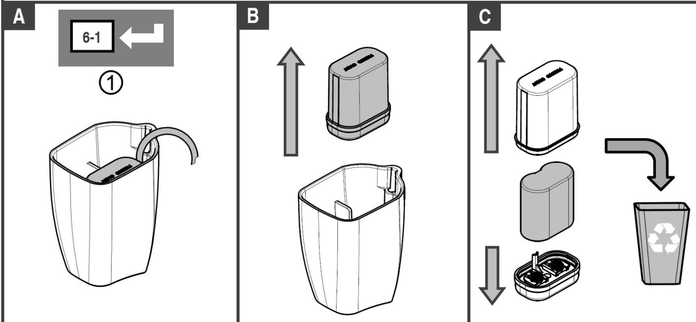
**6-3 Remplacement/ Nettoyage du filtre et electrovanne / Replacing/ Cleaning the filter and the solenoid valve / Filterreinigung / Auswechseln des Magnetventils / Sustitución / Limpieza del filtro y de la electroválvula / Sostituzione / Pulire il filtro e l'elettrovalvola / Vervanging/Reiniging van filter en magneetventiel**
