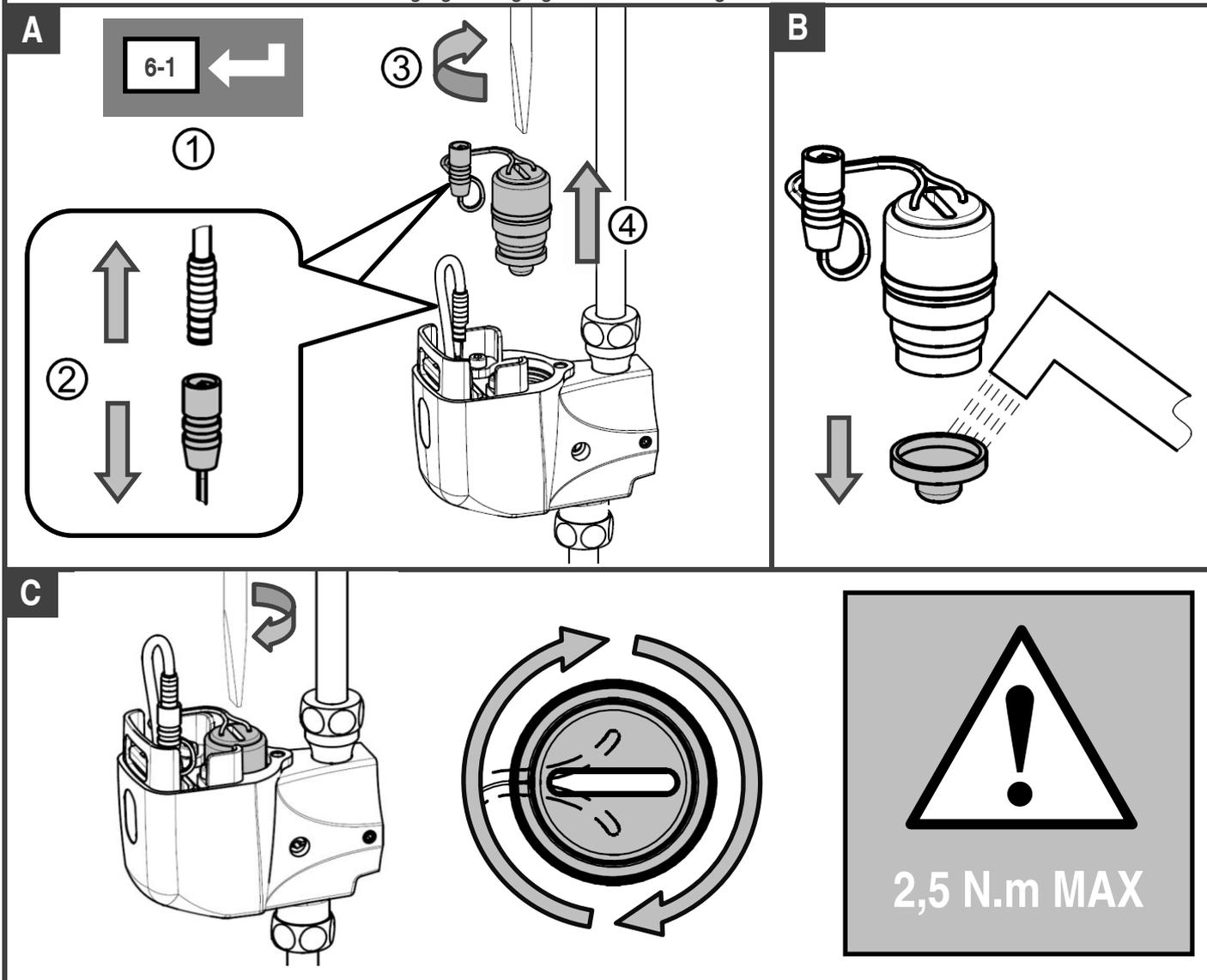
**6-4 Replacement cellule / Replacing the cell / Auswechseln des Sensors / Sustitución de la célula / Sostituzione della fotocellula / Vervanging van de cel**
