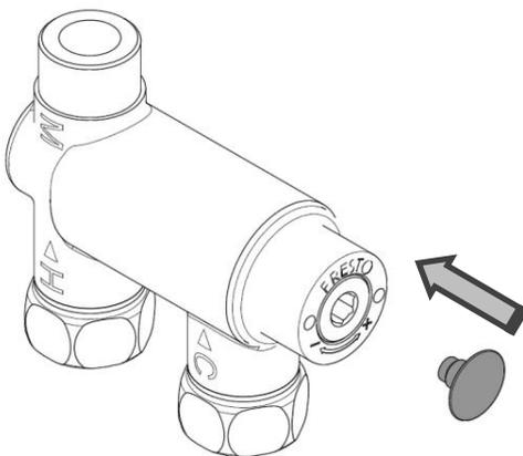
**5 - Réalisation d'un choc thermique / Perform a thermal-shock / Einer manuellen thermische Desinfektion durchführen / Efectuar una desinfección / Effettuare un shock termico / Thermische desinfectie uitvoeren**
