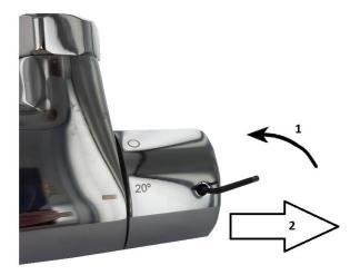
Pour plus d'aisance, tourner le volant de T° en butée à 20°. A l'aide de la clé Allen (1), desserrer la vis puis (2) tirer le volant vers l'extérieur.
