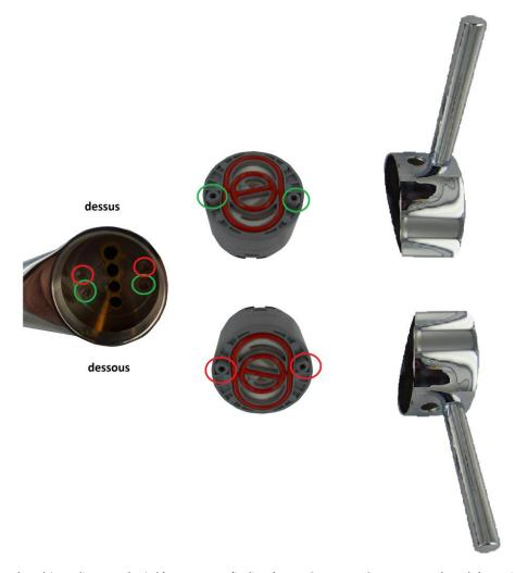
En effet le corps du robinet dispose de 4 détrompeurs (indiqués par 2 verts et 2 rouges sur le schéma ci-dessus). En plaçant la cartouche sur les détrompeurs du dessous (verts, côté bec), la manette de débit sera orientée vers le haut. A l'inverse, en plaçant la cartouche dans les détrompeurs du dessus (rouges), la manette sera alors orientée vers le bas.
