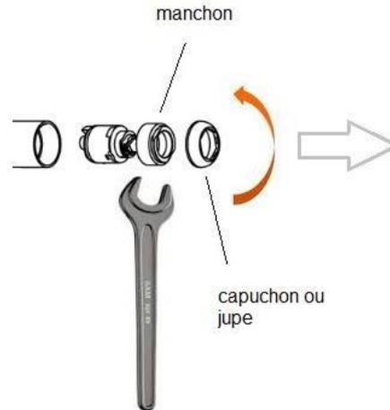
Pour le remontage, il faut procéder dans l'ordre inverse en prenant soin de nettoyer la surface du corps où appuient les joints d'étanchéité de la cartouche. Serrer le manchon (10 Nm) afin de garantir à la fois l'étanchéité et en même temps le mouvement souple de la manette.
