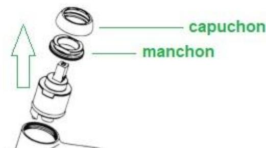
Pour le remontage, il faut procéder dans l'ordre inverse en prenant soin de nettoyer la surface du corps où agissent les joints d'étanchéité de la cartouche. Serrer le manchon (10 Nm) afin de garantir à la fois l'étanchéité et en même temps le mouvement souple de la manette.
