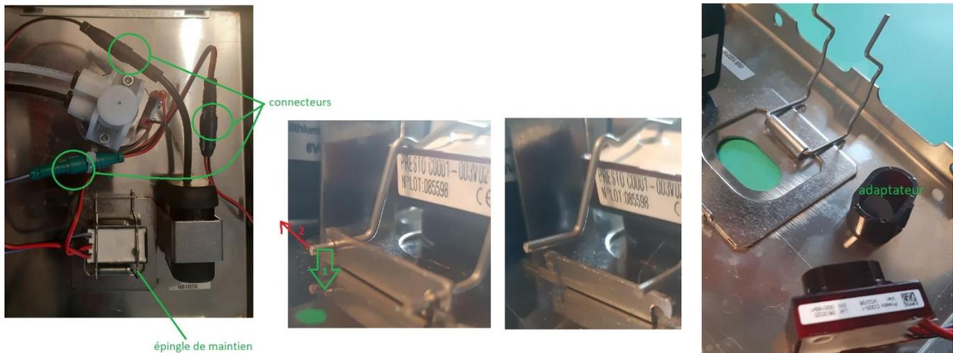
Lever l'épingle de maintien. Extraire la cellule. Récupérer l'adaptateur. Déposer la cellule à remplacer dans un lieu adapté au recyclage. Mettre la nouvelle cellule en place et procéder en ordre inverse pour le remontage.
